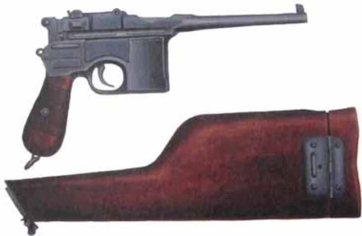
Պ.Մաուզերի 1896թ. ատրճանակը՝ փայտե պատյանով: Այն XX դարասկզբին ամենահեռահար ատրճանակներից էր, ուներ 100 մ նշանառու կրակ վարելու համար նախատեսված նշանոց, որը մեր օրերում էլ ատրճանակների համար պատկառելի թիվ է: Առաջին հանրապետության տարիներին (1918-1920թթ.) այս ատրճանակներով էին զինվում լավագույն ստորաբաժանումները, որոնց ժողովուրդը կոչում էր «մաուզերիստներ»:
