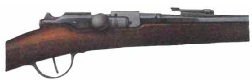
1874թ. արտադրության Գրայի հրացանի կենտրոնական մասը (հարվածածոցային մեխանիզմը, փակադակը և նշանոցը):
