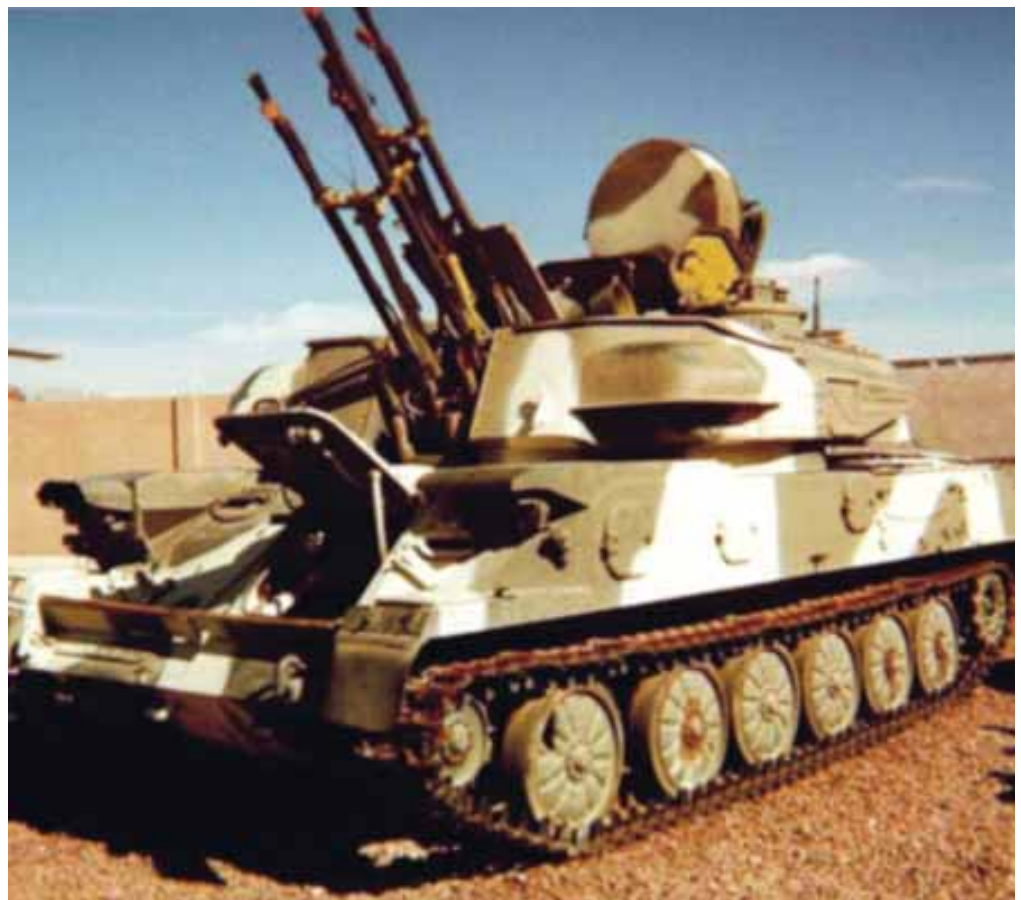
ՋՍՈՒ 23/4 զենիթահրետանային համալիրը փոքր հեռահարության (մինչև 2,5 կմ) ինքնագնաց ՀՕՊ արդյունավետ միջոց է:
