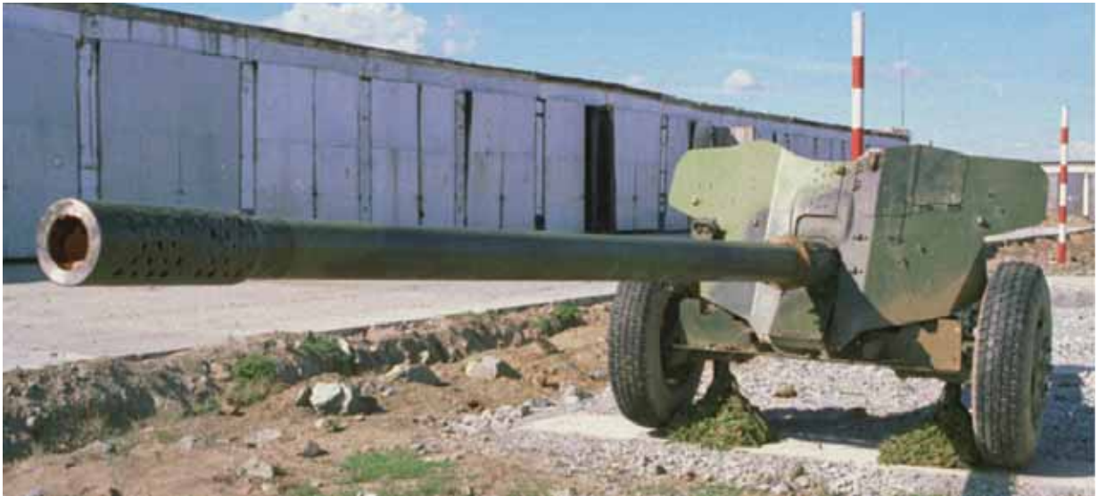
100 մմ տրամաչափի հակատանկային S-12 և դրանց կատարելագործումից հետո՝ 1970թ. սպառազինության վերցված ՍՏ-12 թնդանոթները ԽՍՀՄ ՁՈւ հակատանկային սպառազինության կարևոր մասն էին կազմում:
